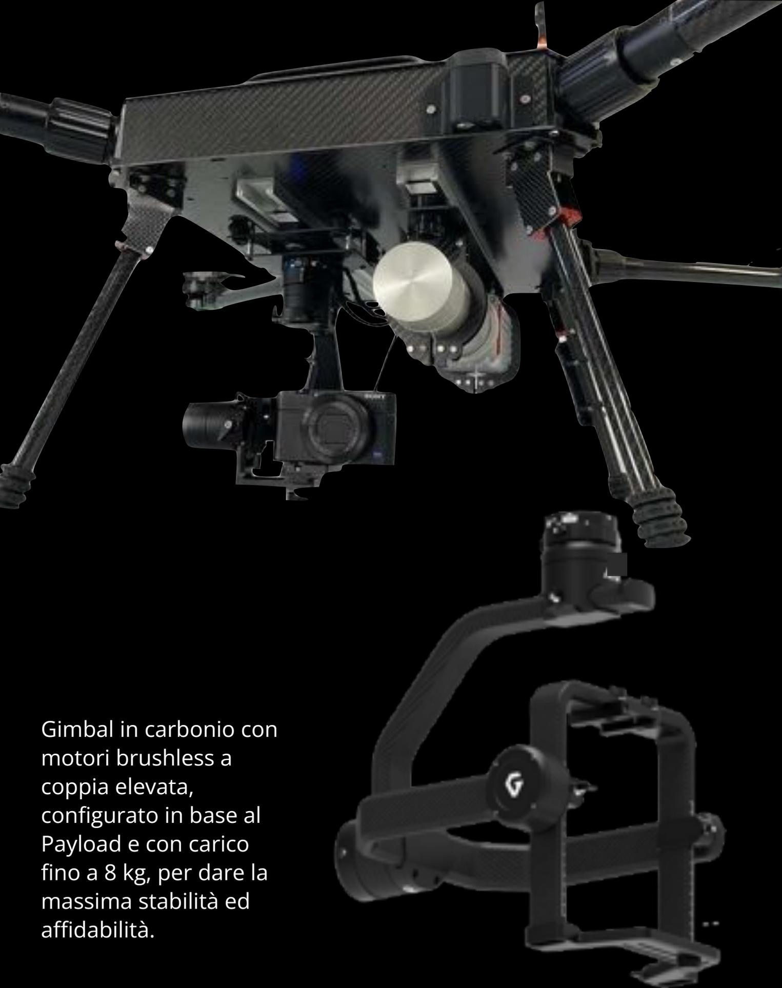
Gimbal in carbonio con motori brushless a coppia elevata, configurato in base al Payload e con carico fino a 8 kg, per dare la massima stabilità ed affidabilità.
