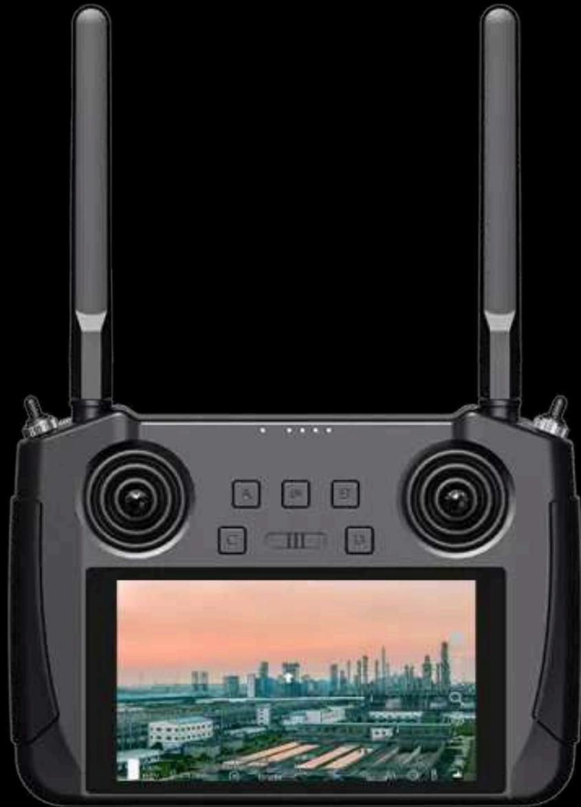
MK15E è uno smart controller Android a lungo raggio con doppio FPV 1080p, basato sulla tecnologia di trasmissione delle immagini ad alta definizione sviluppata da SIYI Technology.
